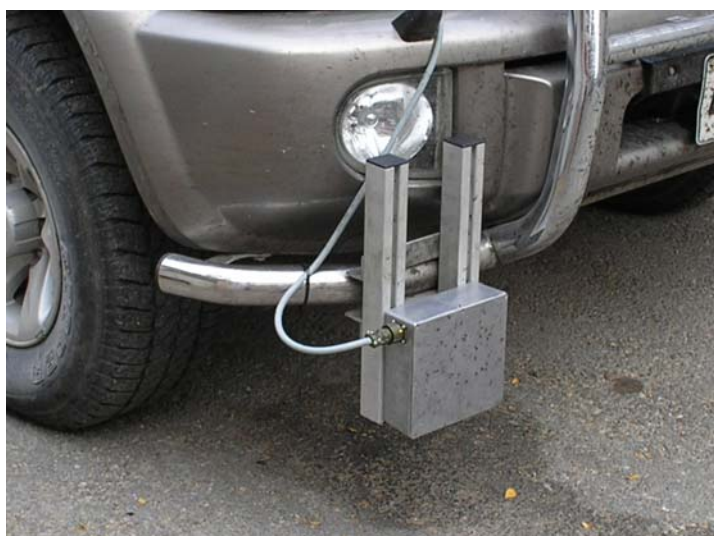
Pilt 1. Teekatte tasasuse mõõtmise seade LaserMASTER
