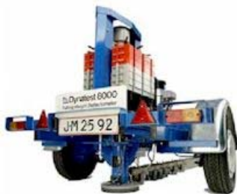
Pilt 1. Kandevõime mõõtmise seade Dynatest FWD 8000, ©Dynatest Denmark
