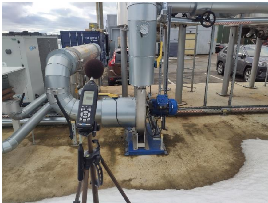
Joonis 2. Tööstusmüra allika mõõtmine (foto ELLE OÜ)
